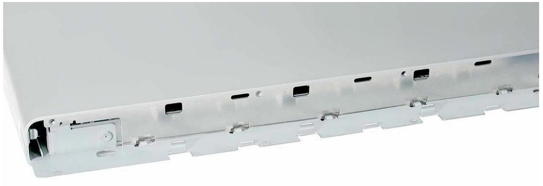
5. 交換用の新しいサイド・チャンネルを取り付け、ディスプレイを元どおりにセットアップしてから動作確認します。
