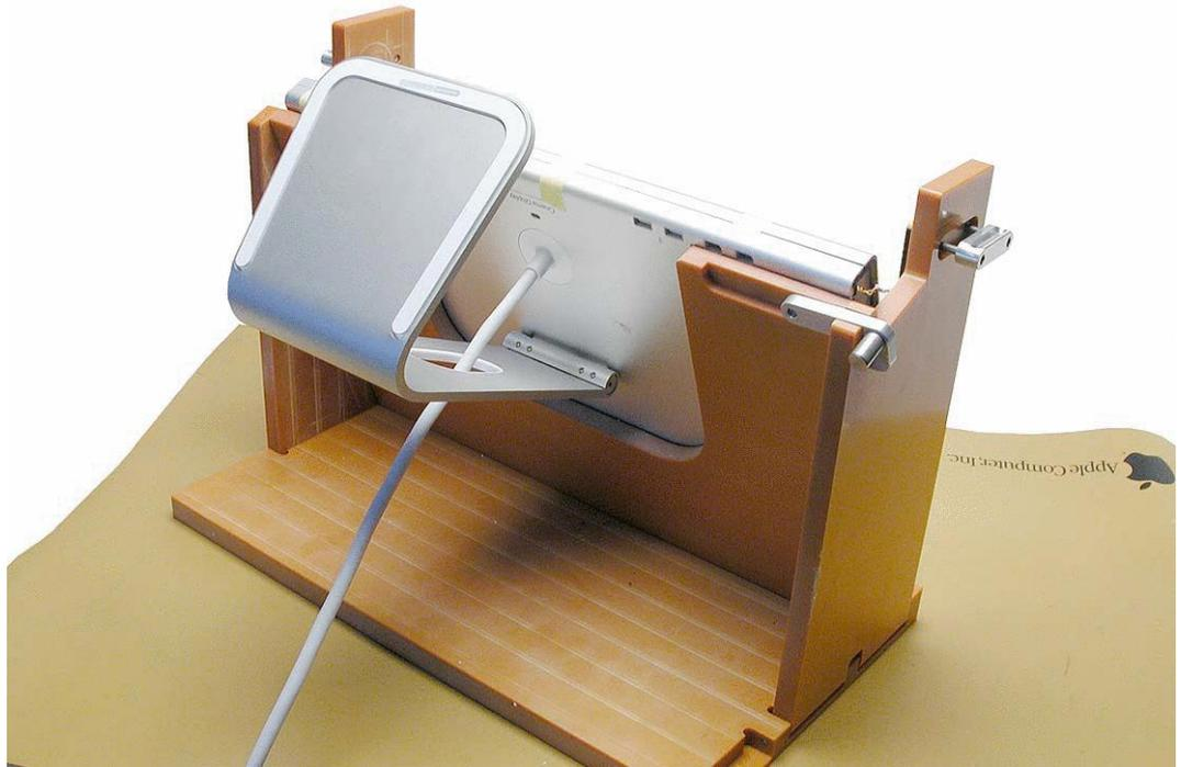
5. ハウジング部の端から先細のラジオペンチを差し込み、継目付近のラッチをつかんで5~6 mmほど引き出します。
