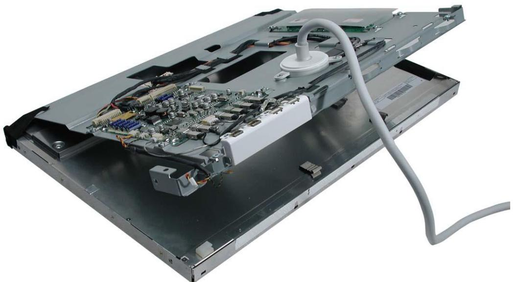
7. 交換用の新しい LCD パネルを取り付け、ディスプレイを元どおりにセットアップしてから動作確認します。
