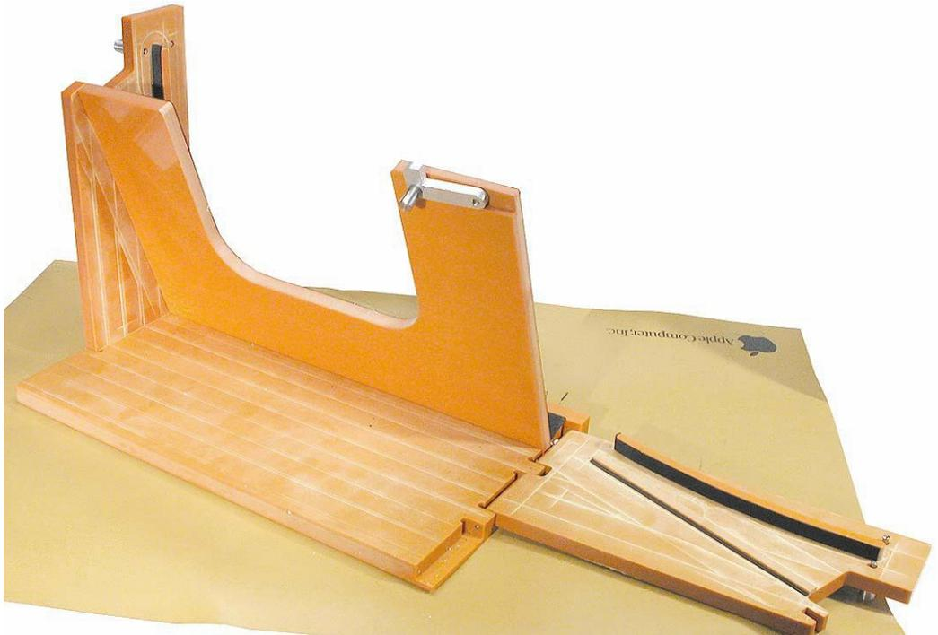
3. 両手でディスプレイの側面部を持ち、ディスプレイを上下逆にして固定台の所定の場所に入れます。
