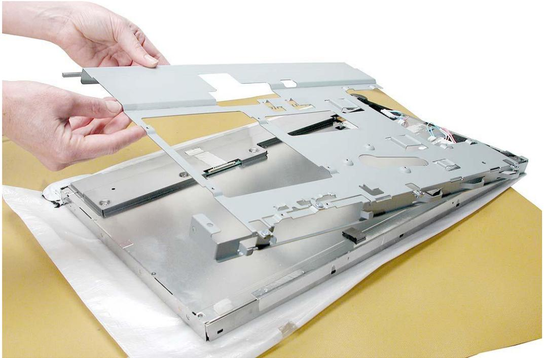
4. 交換用の新しいシャーシを取り付け、ディスプレイを元どおりにセットアップしてから動作確認します。
