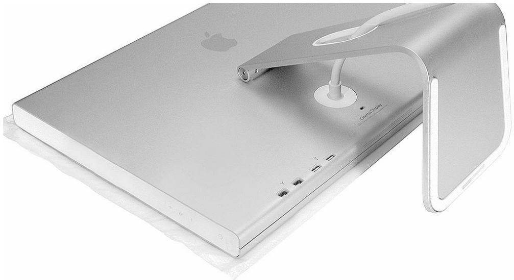
2. 黒色スティックを使い、右側のエンド・キャップをディスプレイ・ハウジングから少しずつ浮かせます。ディスプレイ底面側の継目（タッチ・スイッチ・パネル付近）から慎重に作業を始めてください。
