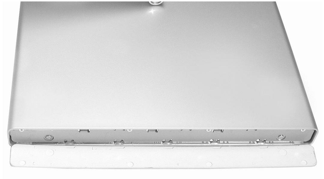
**取り付けに際して:** エンド・キャップに緩みがなく、ディスプレイの側面から浮き上がることもなく、まっすぐに正しく取り付けられていることを確認してください。
